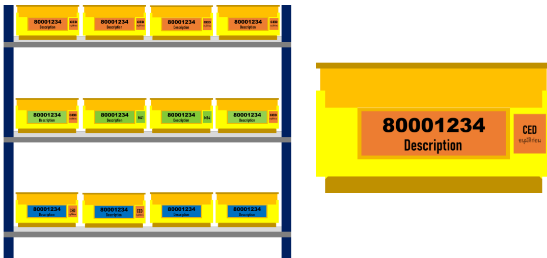
ภาพที่ 3 ภาพตัวอย่างการติดบ่งชี้สถานะของวัสดุภายในชั้นวาง ที่มา: บริษัท ทูลิ่ง แมชชีน กรุ๊ป จำกัด (มหาชน)
